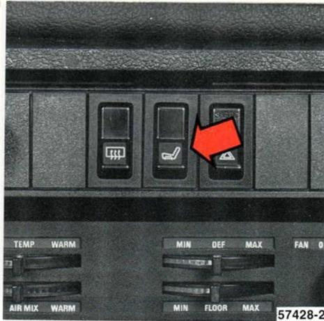
*Interruptor para calentamiento del asiento del conductor*
