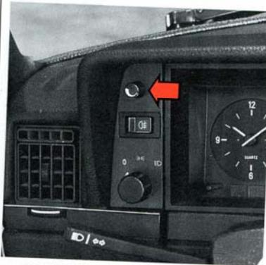
Reostato, iluminación de instrumentos
