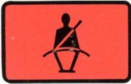
Dos testigos luminosos, uno en el panel central y otro entre los asientos posteriores, dan una señal intermitente cuando Ud. y el pasajero del asiento delantero no usan el cinturón de seguridad, incluso una frenada brusca puede ser peligrosa si no se utilizan los cinturones de seguridad.
